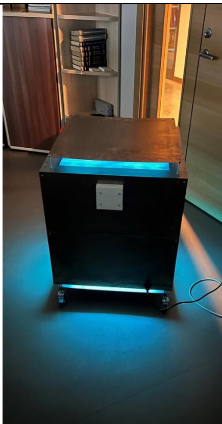
Att. 1. Automātiski uz riska modeļa bāzes vadāmās gaisa attīrīšanas iekārtas prototips
